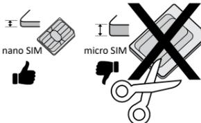
Legen Sie die SIM-Karte ein, die Sie von Ihrem Mobilnetzbetreiber erhalten haben. Achten Sie darauf, dass die Kontakte der SIM-Karte nach innen zeigen und dass die abgeschrägte Kante so ausgerichtet ist, wie auf der Abbildung gezeigt. Wenn Sie die SIM-Karte entfernen/austauschen müssen und Probleme beim Entfernen haben, kleben Sie ein Stück Klebeband auf den freiliegenden Teil der Karte und ziehen Sie sie damit heraus.
